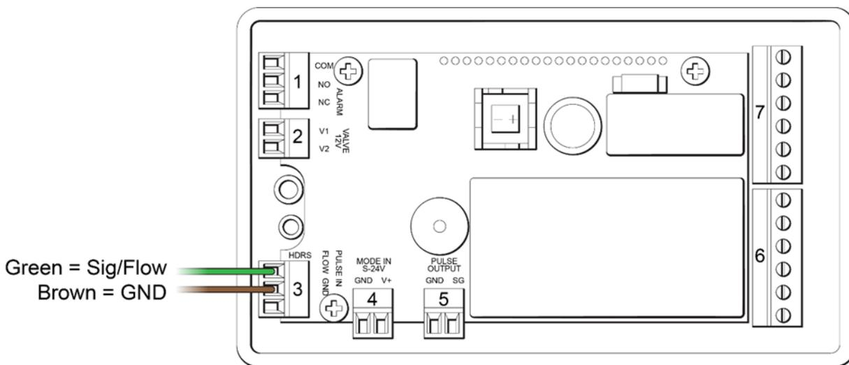
Figure 4. Meter Wiring Diagram
